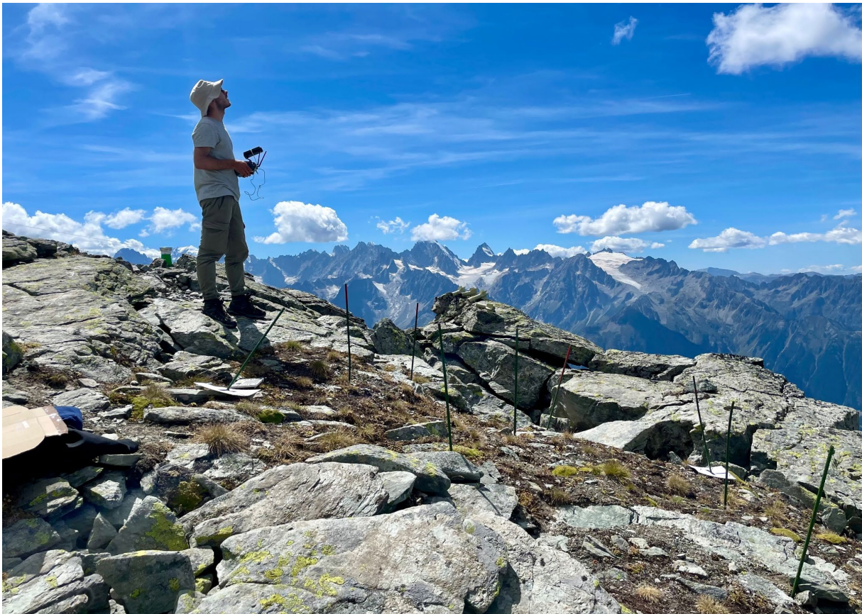
Fig. 1. UNIL-Masterstudent Aurélien Robadey bei einem Drohnenflug auf der Pointe du Parc (Wallis). Aus den Bildern der Drohne lässt sich ein Geländemodell mit einer Auflösung von wenigen Zentimetern ableiten. (Foto: C.Randin)
