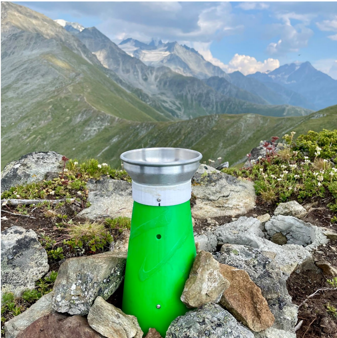
Fig. 2. Ein Regenmesser mit einem Big-Drip-Sensor der Firma Goodsell System Ltd. auf dem Gipfel des Mont Brûlé (Wallis). (Foto: C.Randin)
